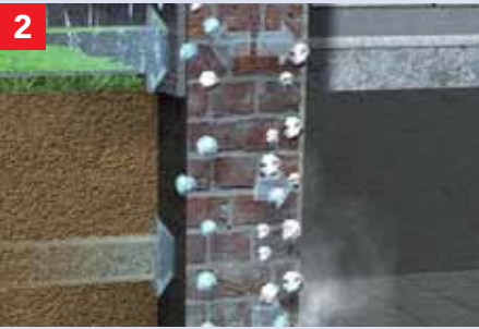
Hygroscopisch vocht Zouten in muren hebben de eigenschap (hygroscopiciteit) vocht uit de lucht en de omgeving op te nemen en dit in het bouw materiaal op te slaan
