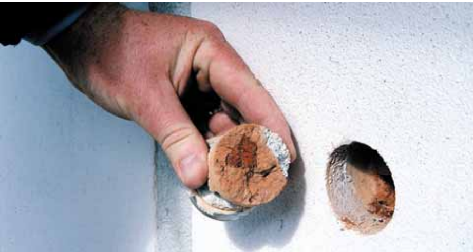
Boorkern voor het bepalen van vocht- en zoutgehalte
