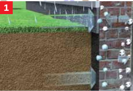
Regen- en spatwaterbelasting Vocht dringt als gevolg van een slechte afdichting door in het metselwerk
