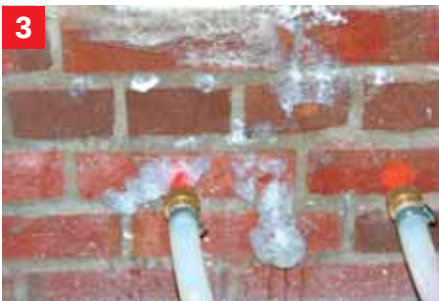
3 Wateruittreding Grootschalige luchtverdeling in de muur.
